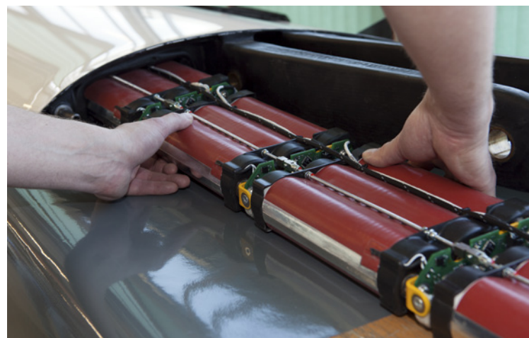
»A piece of cake« – Der Austausch der Akkus erfolgt über die Flügelwurzel.
